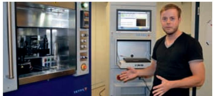
*Nach dem Prinzip der Zwei-Photonen-Polymerisation (2PP) arbeitet eine von TETRA entwickelte Laseranlage zur Erzeugung von Nanostrukturen, die Entwicklungsingenieur Thomas Kowallik vorstellte. Foto: wr*
