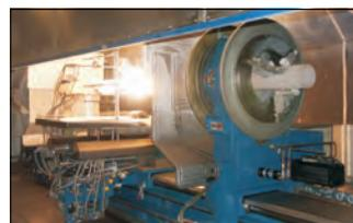
*Herstellung von Quarzglas-Hohlzylindern in der QSIL GmbH. Foto: wr*
