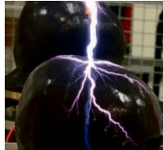
Langzeitbelichtung eines Experiments mit einer Blitzentladung auf einem Kunstkopf | © TU Ilmenau/René Machts
